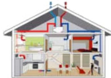
Aanleg balansventilatiesysteem in een woning
